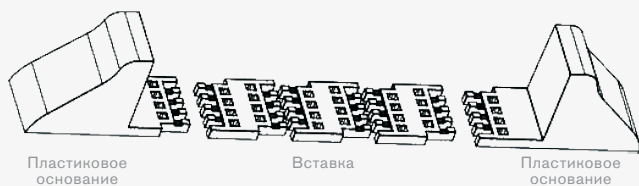
Рис. 5-1(в) Подставка для ИБП совместно с батарейным кабинетом
